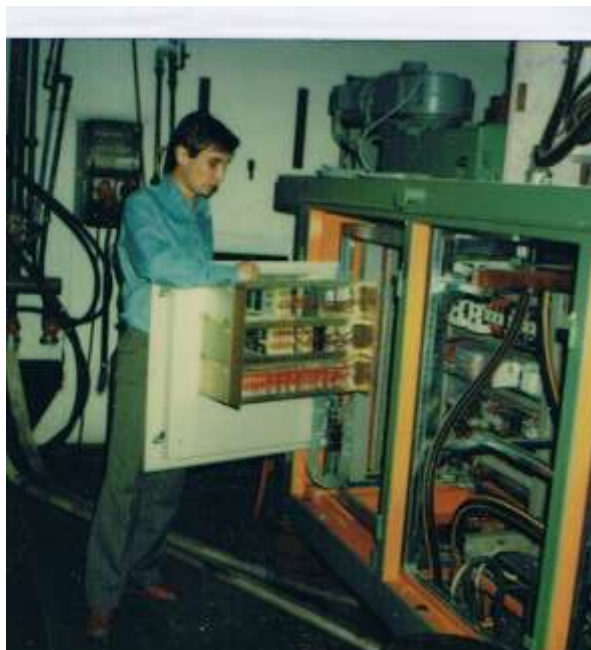
Dr Jan Fabjanowski podczas uruchamiania falownika prądu do grzania indukcyjnego dla Zakładów Mechanicznych „Zgoda” w Świętochowicach (fot. Archiwum dr M.A. Dzieniakowskiego)
