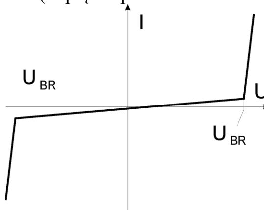
Rys.1.6. Charakterystyki w stanie blokowania i zaworowym z uwzględnieniem zjawiska przebicia.
