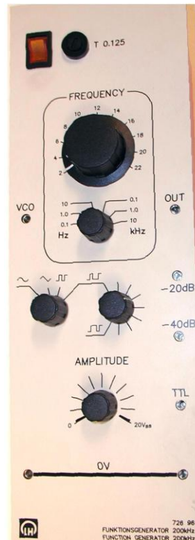
Rys. 4.13. Panel z generatorem funkcyjnym
